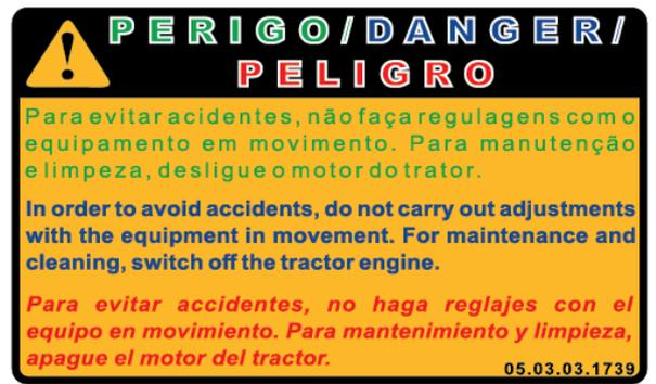
Etiqueta adesiva "Para evitar acidentes, não faça regulagens com o equipamento em movimento. Para manutenção e limpeza, desligue o motor do trator."
