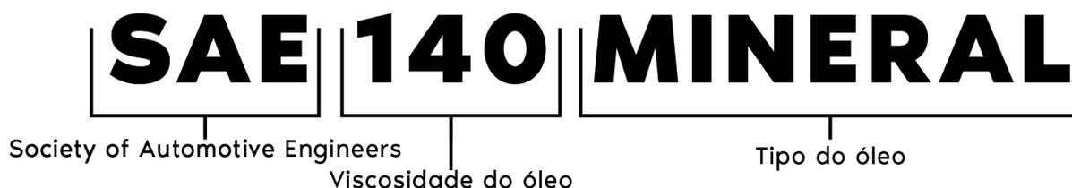
Portanto, "SAE 140 mineral" indica um óleo de transmissão com uma viscosidade específica de 140 de extrema pressão, derivado de fontes minerais.
